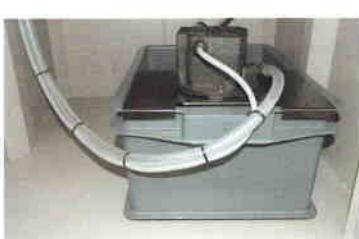
Vasca refrigerante di 20 l posizionata all'interno del basamento facilmente asportabile per la pulizia e il riempimento.
