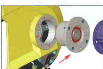
Gruppo flangia con cuscinetti conici contrapposti a sostegno del volano motore, soluzione che permette di preservare il riduttore dagli sforzi causati dalla tensionatura della lama e quindi di garantirne una lunga vita.
