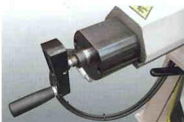
Morsa chiusura materiale in ghisa a posizionamento manuale, dotata di cilindro di chiusura idraulico.
